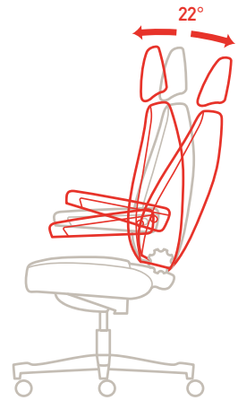
Inclinazione aggiuntiva dello schienale. Additional backrest inclination.
