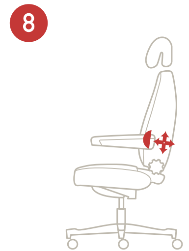
8 Regolazione in profondità (S2) e altezza (S4 - optional) del supporto lombare. Depth (S2) and Height (S4 - optional) adjustment of lumbar support.
